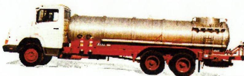
Figura 2. Caminhão com veículo motor e carreta unidos permanentemente (Masa®).
