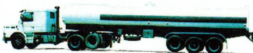
Figura 3. Caminhão com veículo motor e carreta acoplados por pino-rei (Masa®).
